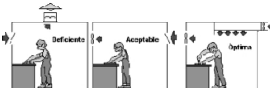
Figura 8-3: VENTILACIÓN GENERAL. DISTRIBUCIÓN DEL AIRE
