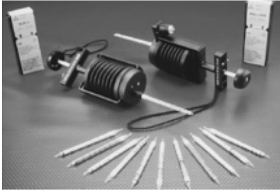
Figura 5-11: BOMBAS ACCURO Y AUER GAS-TESTER CON TUBOS COLORÍMETROS
