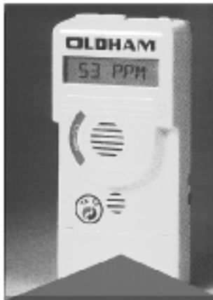
Figura 5-15: EQUIPOS DE LECTURA DIRECTA PARA GASES O VAPORES
