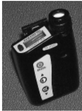
Figura 5-8: EQUIPO DE TOMA DE MUESTRAS PERSONAL DE CONTAMINANTES QUÍMICOS
