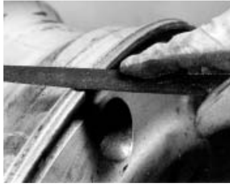
Foto 4. Eliminación del borde afilado a mano utilizando una lima de metal.
