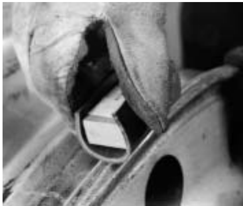
Foto 2. Un calibre de filo de hule fabricado con una sección de cara lateral de llanta o un trozo adecuado de hule sujeto a un bloque de madera
