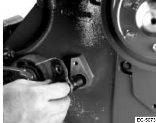
Figura 11.38 Retiro del CMP
