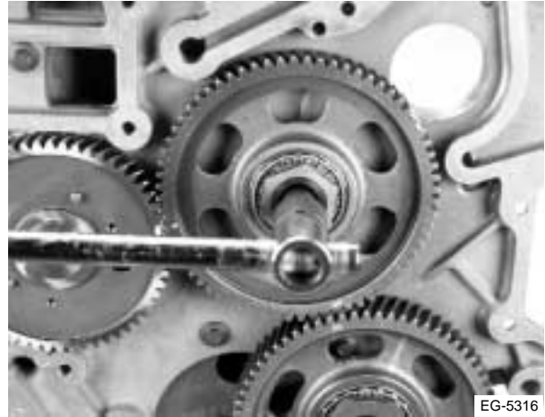
Figura 8.20 Retiro del engranaje libre superior
