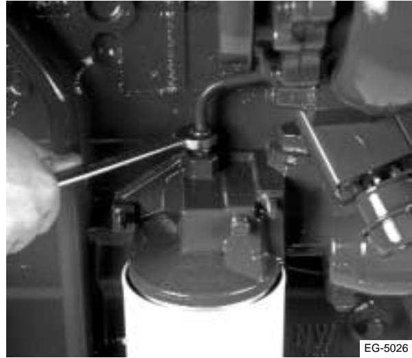
Figura 9.16 Retiro del tubo de suministro de aceite
