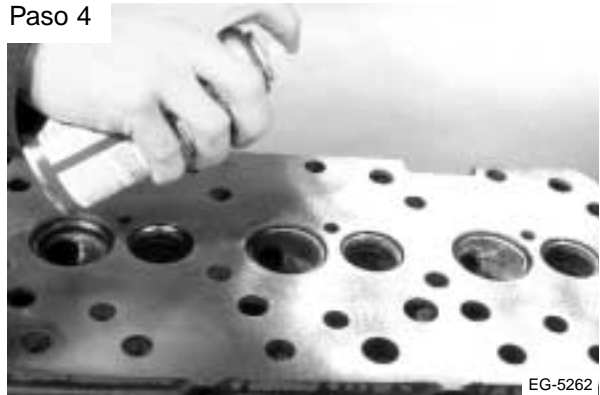
Figura 4.26 Inspección por fisuras
