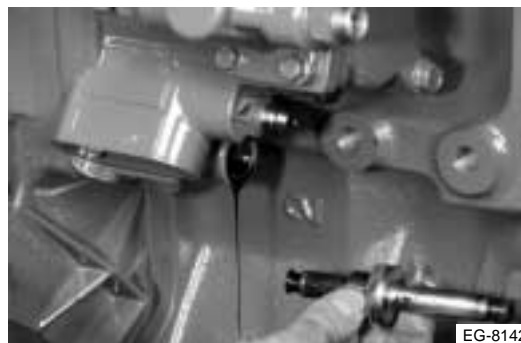
Figura 12.19 Instalación del IPR
