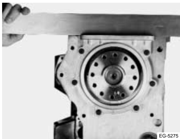
Figura 7.22 Alineación del soporte del sello
