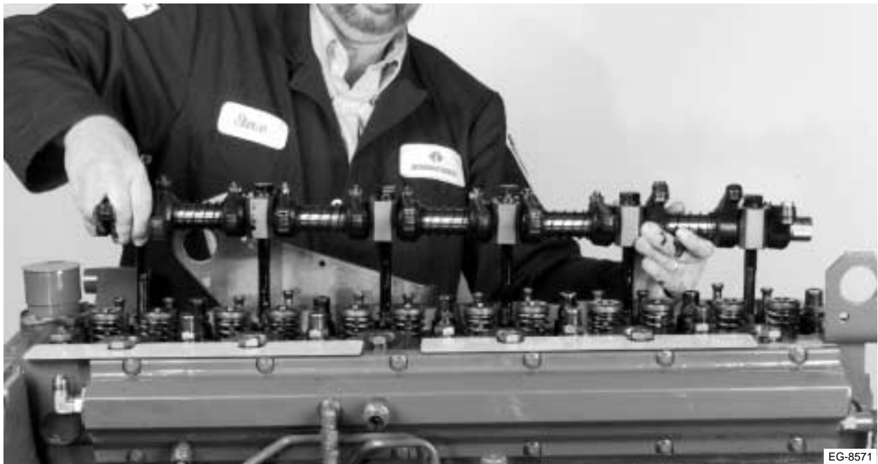
Figura 5.2 Retiro del conjunto de balancines
