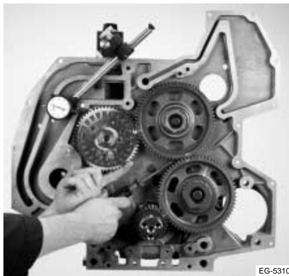
Figura 8.18 Revisión del juego longitudinal del engranaje del árbol de levas
