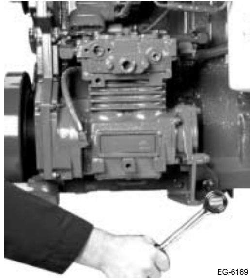
Figura 8.11 Retiro de los pernos que sujetan el compresor de aire al bloque del motor
