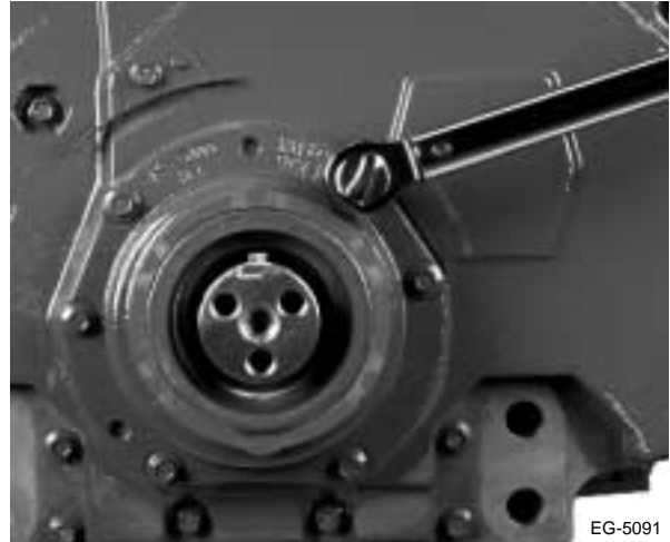
Figura 9.15 Ajuste de los pernos de montaje de la caja protectora de la bomba de aceite
