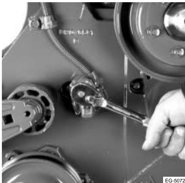
Figura 11.32 Retiro del CMP
