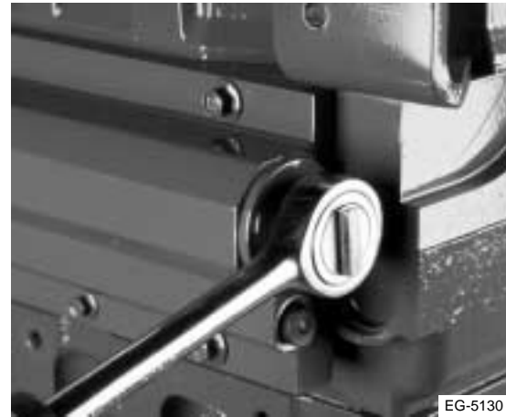
Figura 4.9 Retiro del tapón de extremo
