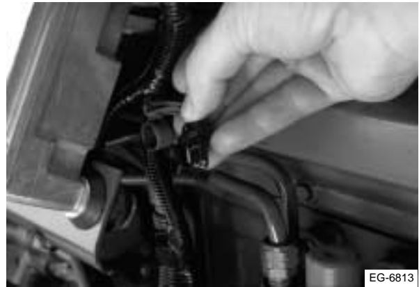
Figura 11.27 Retire el conector del ICP
