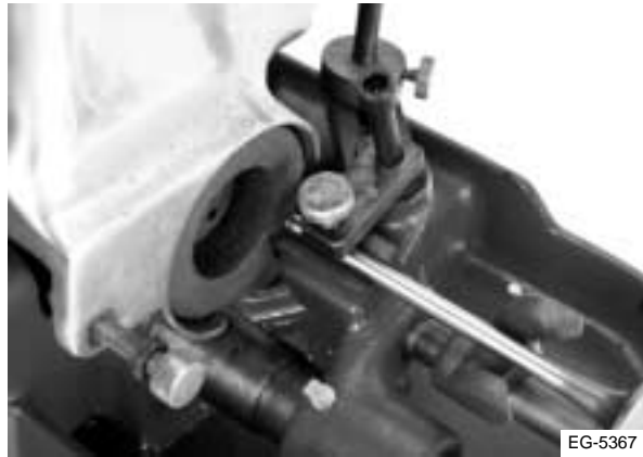
Figura 4.43 Coloque la válvula en el esmerilador
