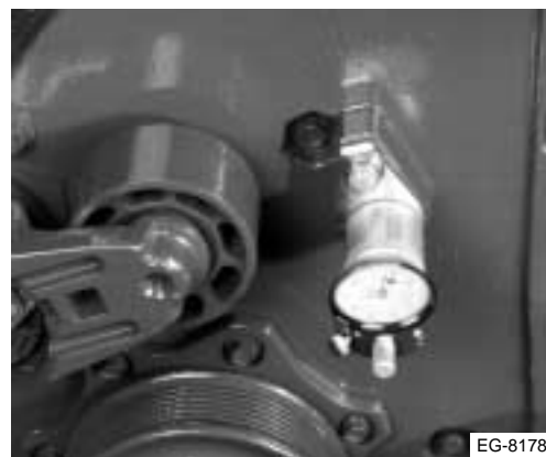
Figura 11.40 Medición de la holgura del CMP
