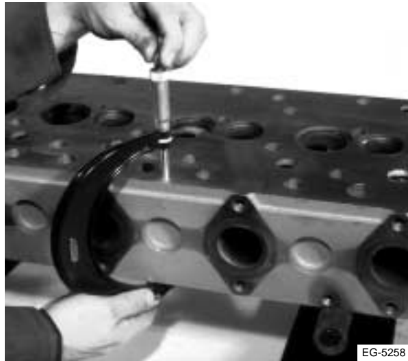
Figura 4.25 Medición del grosor
