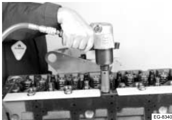
Figura 4.21 Retiro de los pernos de montaje
