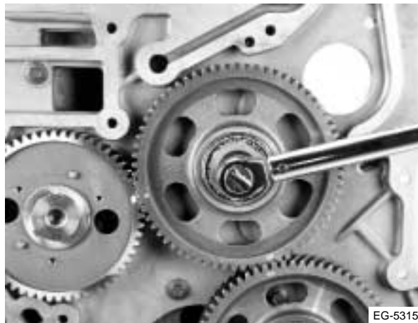
Figura 8.26 Instalación del engranaje libre superior
