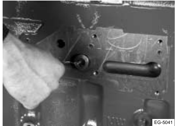
Figura 1.9 Retiro de la válvula reguladora
