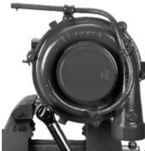
Figura 2.23 Instalación de la caja protectora del compresor
