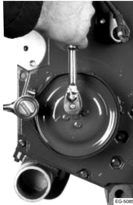
Figura 10.2 Retiro de la polea de la bomba de agua
