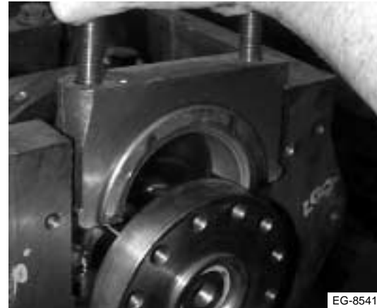
Figura 7.67 Retiro del cojinete trasero de empuje
