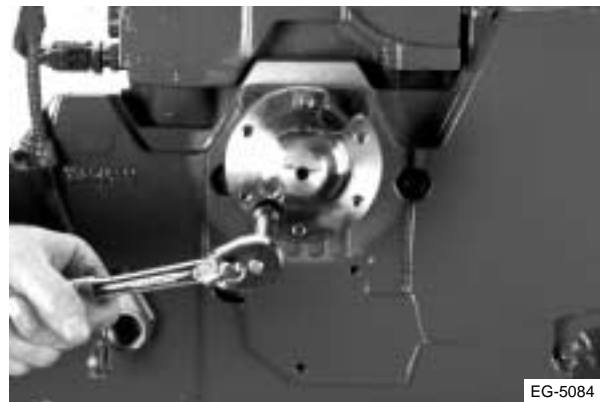
Figura 8.7 Retiro del núcleo impulsor del ventilador
