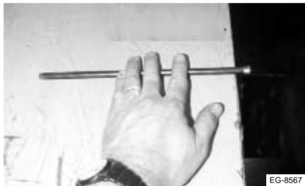
Figura 5.33 Haga rodar las varillas de empuje a ver si están derechas
