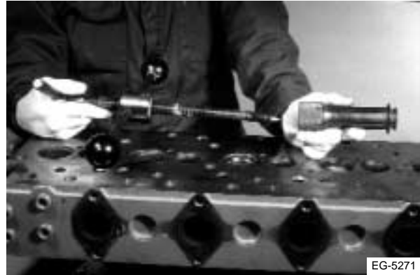
Figura 4.50 Instalación de la boquilla en el mango
