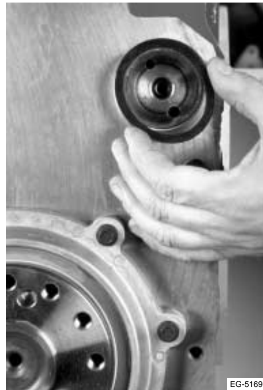
Figura 7.24 Instalación del anillo O del árbol de levas
