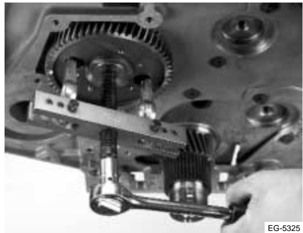
Figura 5.20 Retiro del engranaje fuera del árbol de levas con el extractor de engranajes
