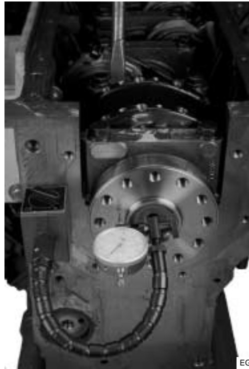
Figura 7.83 Comprobación del juego longitudinal del cigüeñal
