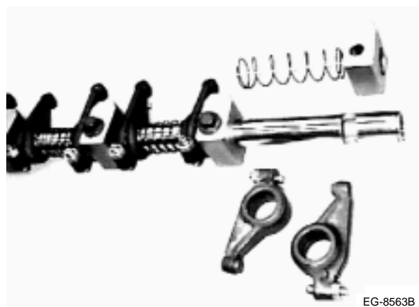
Figura 5.15 Ensamblaje del conjunto de balancines
