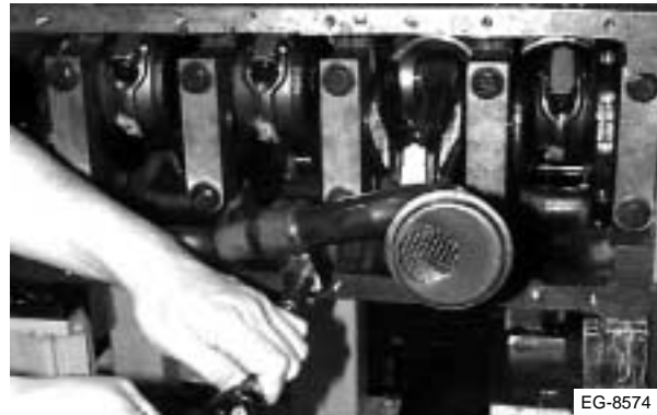
Figura 7.63 Retiro del soporte del tubo de captación de aceite
