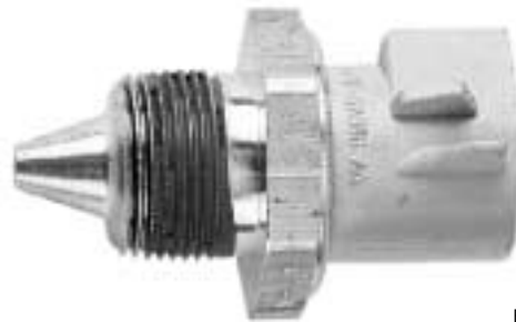
Figura 11.43 Sensor de la temperatura del refrigerante / Sensor de la temperatura del aceite del motor
