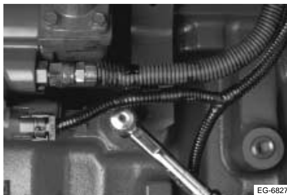
Figura 11.18 Perno inferior del soporte de montaje
