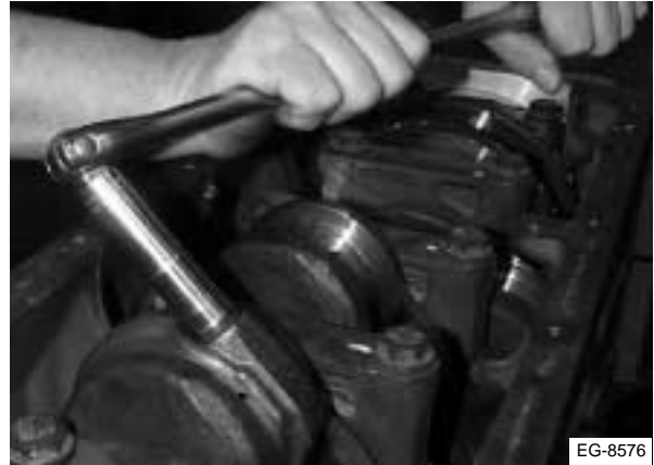
Figura 6.2 Retiro de los pernos de montaje de las bielas
