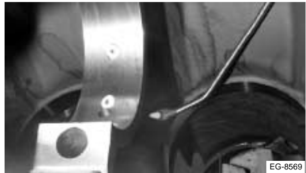
Figura 7.76 Inspección de los tubos aspersores de aceite de los pistones
