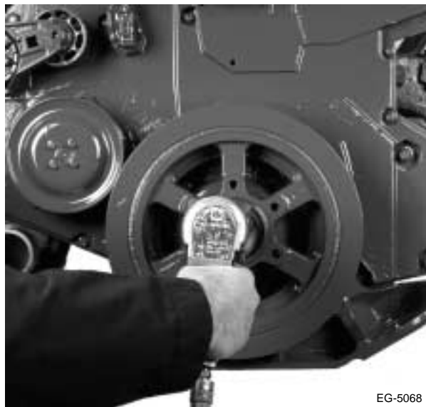
Figura 7.59 Retiro del retenedor del amortiguador de vibraciones
