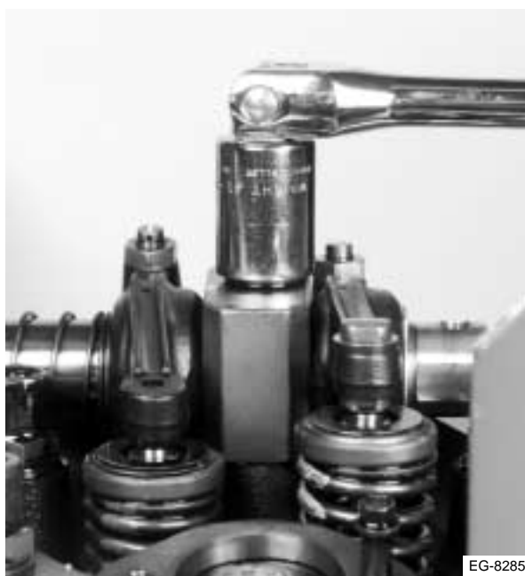
Figura 4.18 Retiro de los pernos de montaje
