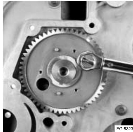
Figura 5.34 Fijación de la placa de empuje
