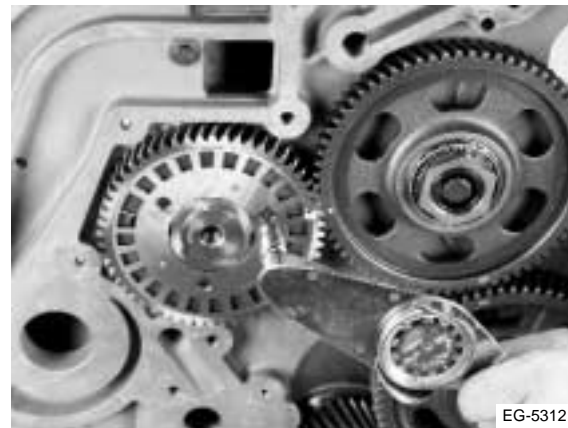
Figura 5.35 Instalación del disco de sincronización
