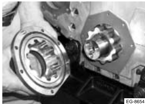
Figura 9.14 Instalación de la caja protectora de la bomba de aceite
