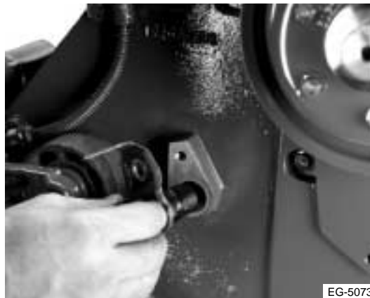
Figura 11.33 Instalación del CMP
