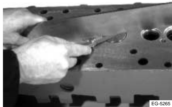
Figura 4.48 Verificación de la depresión de la válvula con regla y láminas calibradas
