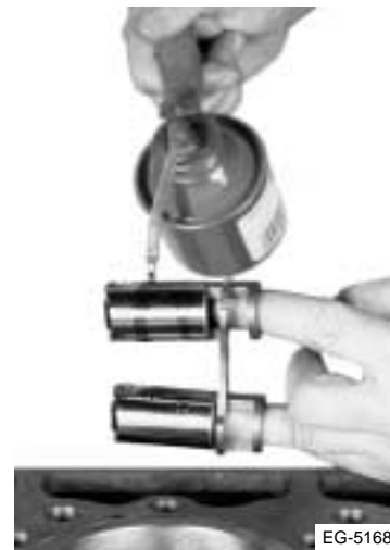
Figura 5.36 Lubriqué las guías y los levantaválvulas de rodillo
