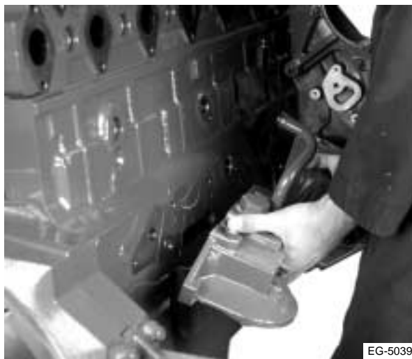
Figura 1.8 Retiro del enfriador de aceite
