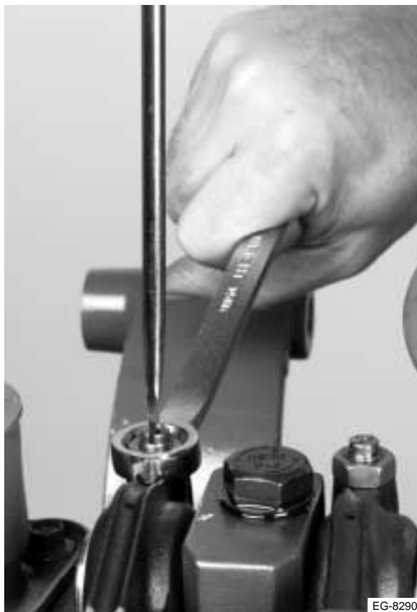
Figura 4.17 Afloje los tornillos de ajuste
