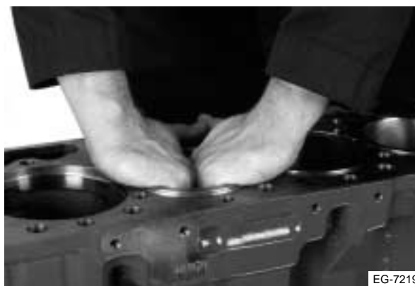
Figura 6.46 Instalación de las camisas
