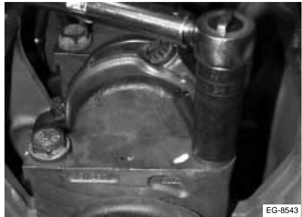
Figura 7.82 Instalación de las tapas de los cojinetes de bancada
