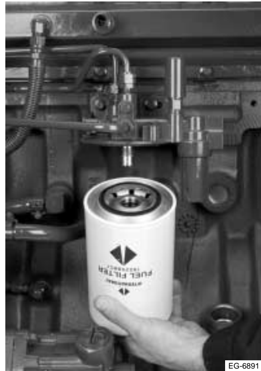
Figura 13.16 Instalación del filtro de combustible
