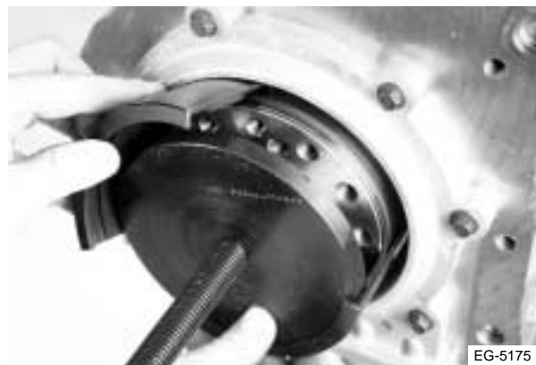
Figura 7.11 Instalación del collar en 3 partes de la herramienta extractora
