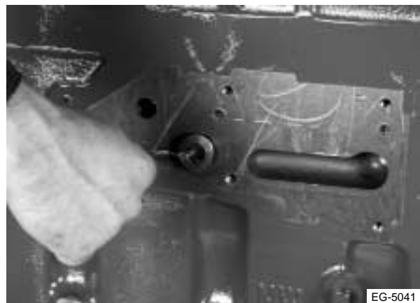
Figura 9.21 Ubicación de la válvula reguladora de la presión de aceite
