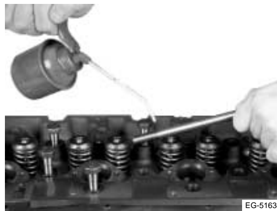
Figura 4.73 Instalación de los pernos de montaje
