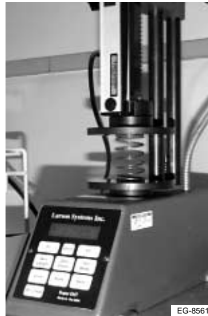
Figura 5.14 Medición de tensión de los resortes
