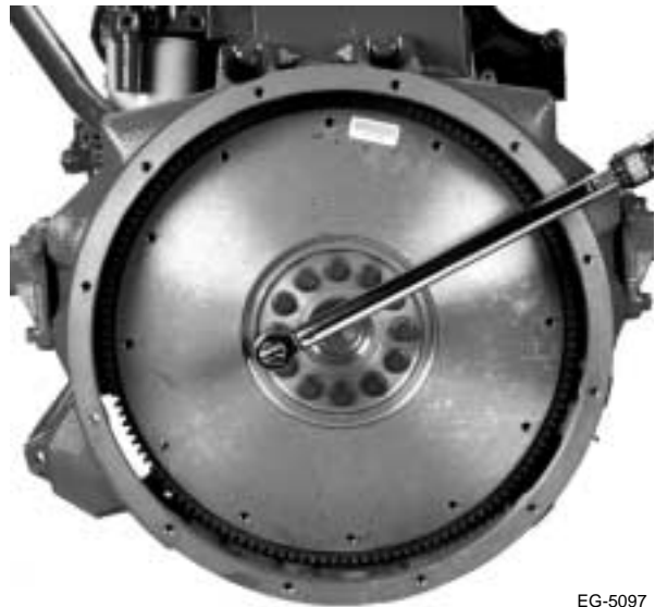
Figura 7.30 Instalación del volante
