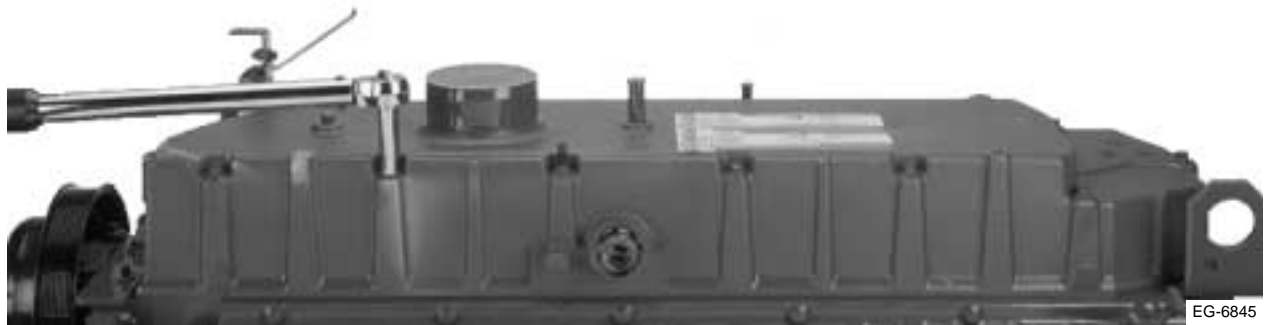
Figura 3.11 Instalación de la tapa de válvulas / múltiple de admisión
