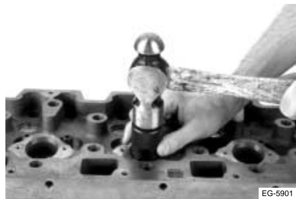
Figura 4.65 Instalación de la camisa
