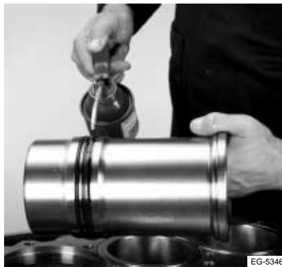
Figura 6.44 Lubrique la camisa y los anillos
