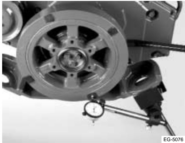
Figura 7.58 Inspección del amortiguador de vibraciones en busca de desviación
