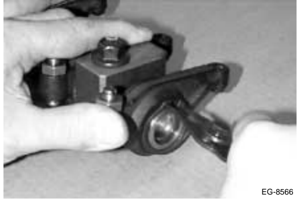
Figura 5.6 Retiro del anillo de retención
