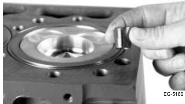
Figura 4.71 Instalación de los anillos de media caña
