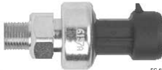
Figura 11.44 Sensor de la presión del aceite del motor
