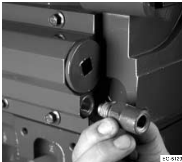
Figura 12.24 Instalación de la válvula de retorno
