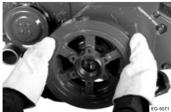
Figura 7.96 Instalación del amortiguador de vibraciones
