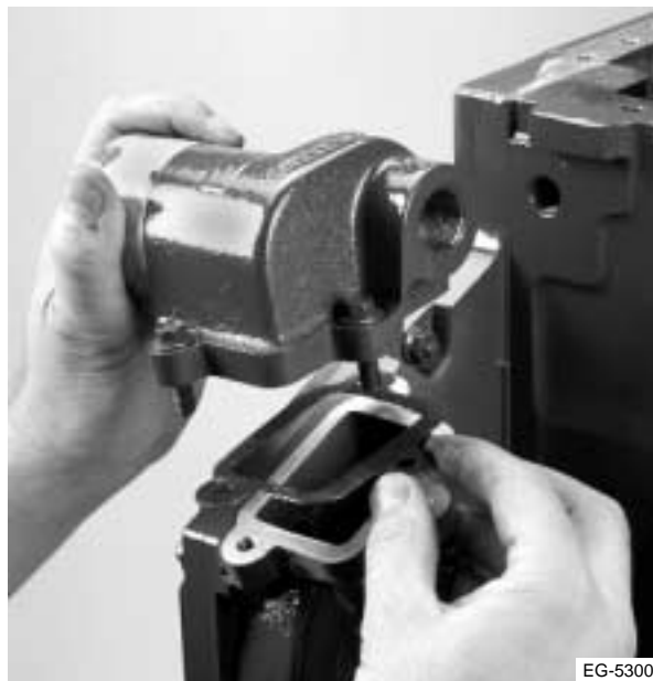
Figura 10.17 Instalación del codo de entrada de agua
