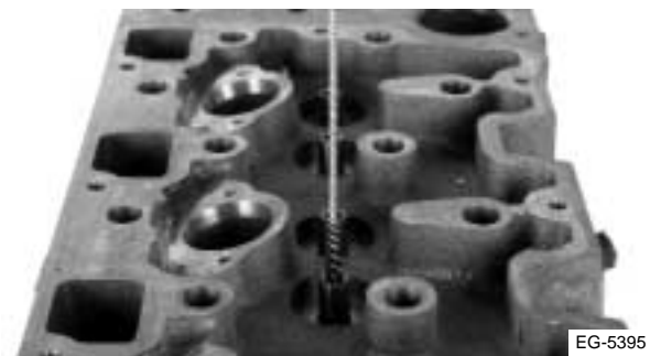
Figura 4.34 Limpieza de las guías
