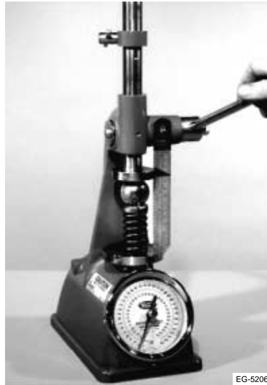
Figura 4.57 Revisión del rotador
