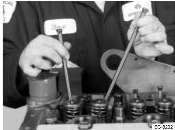
Figura 4.74 Instalación de las varillas de empuje
