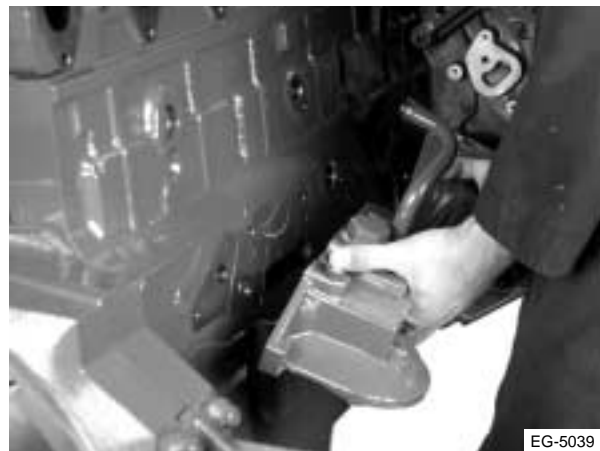
Figura 9.19 Retiro del enfriador de aceite
