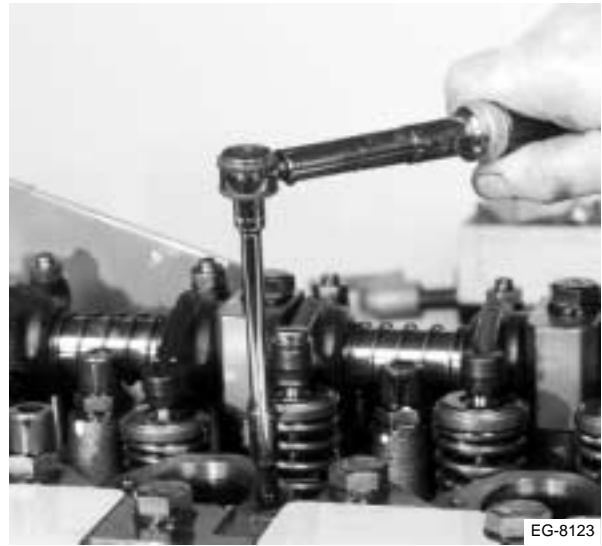
Figura 4.88 Instalación del perno de resalto
