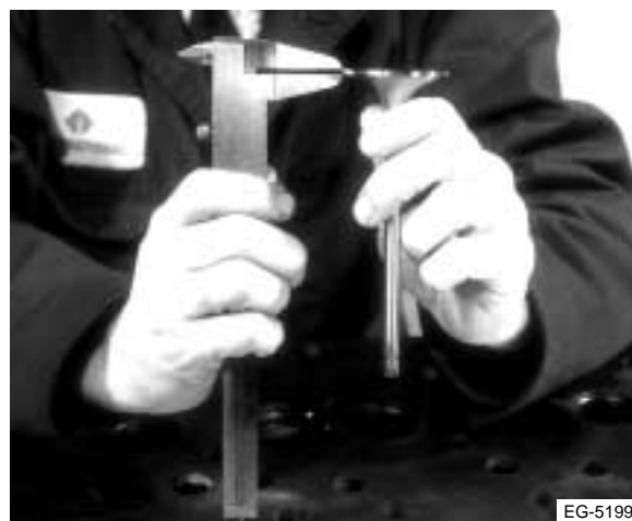
Figura 4.42 Medición del margen de la cara de la válvula
