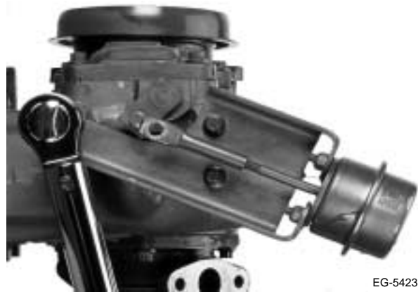
Figura 2.20 Instalación del soporte del impulsor de la compuerta de descarga
