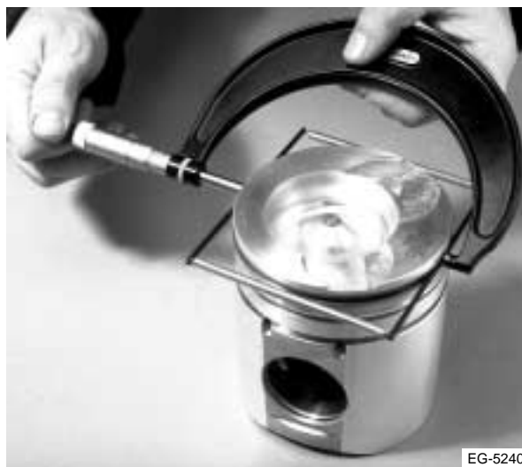
Figura 6.12 Mida el diámetro de cada pistón
