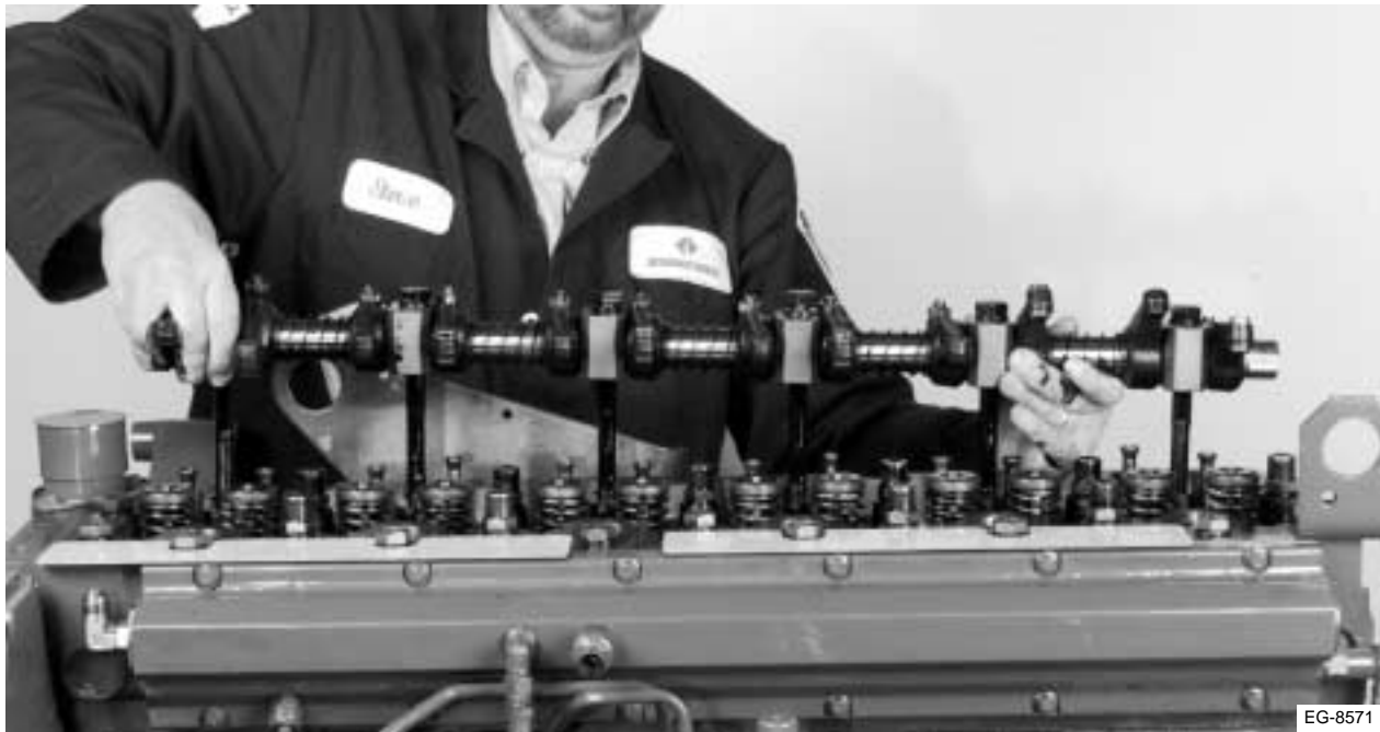
Figura 4.19 Retiro de los balancines
