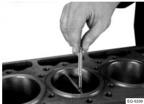
Figura 6.20 Mida el diámetro interior de la camisa
