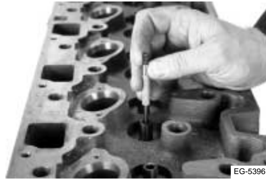
Figura 4.35 Medición de las guías
