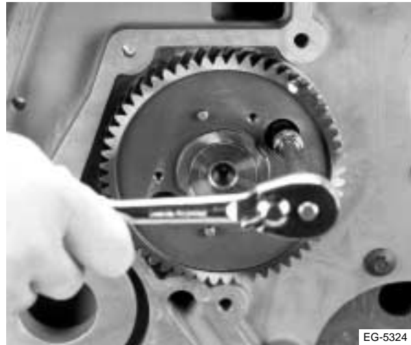
Figura 5.23 Retiro de los pernos de la placa de empuje del engranaje
