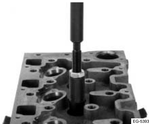
Figura 4.38 Uso del instalador de guías
