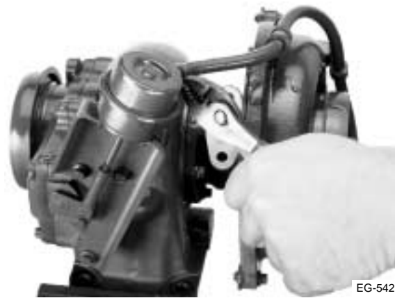
Figura 2.11 Retiro de las abrazaderas
