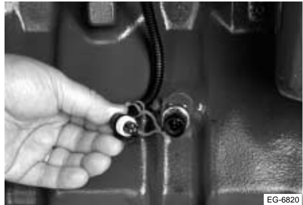
Figura 11.29 Retire el conector del EOP
