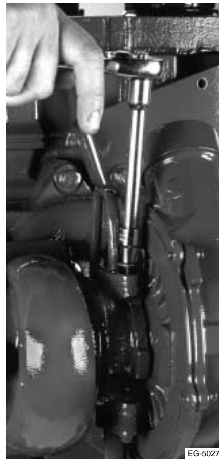
Figura 2.25 Instalación del tubo de suministro de aceite
