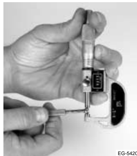
Figura 4.36 Medición del calibre de las guías
