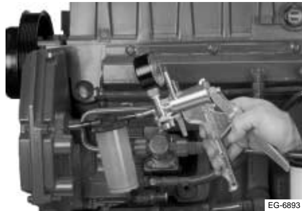
Figura 12.17 Retiro del aceite del depósito
