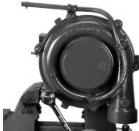
Figura 2.14 Retiro de la caja protectora del compresor
