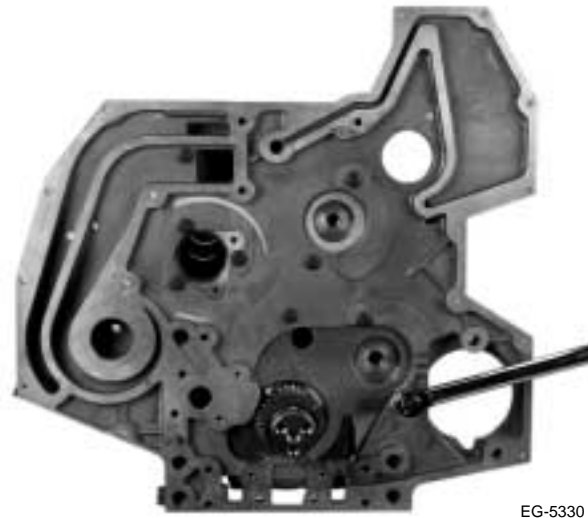
Figura 8.23 Instalación de la mitad trasera de la tapa delantera en el bloque del motor
