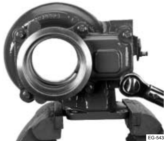
Figura 2.18 Retiro de la caja protectora de la compuerta de descarga
