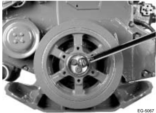
Figura 7.98 Ajuste del retenedor del amortiguador de vibraciones
