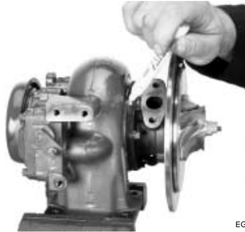
Figura 2.16 Haga marcas en la turbina y en la caja protectora central
