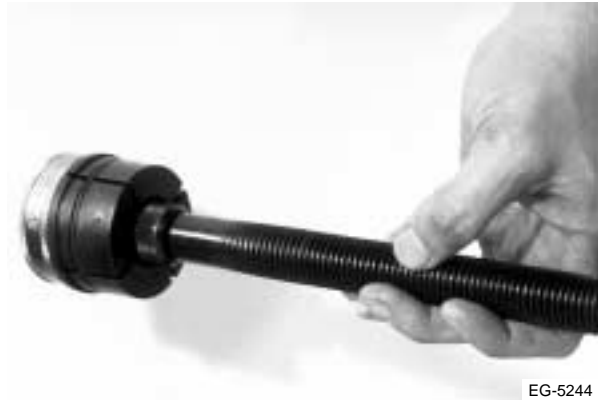
Figura 5.30 Colocación de un buje nuevo en la boquilla expandible
