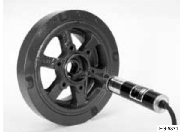
Figura 7.94 Uso del calentador de amortiguador de vibraciones
