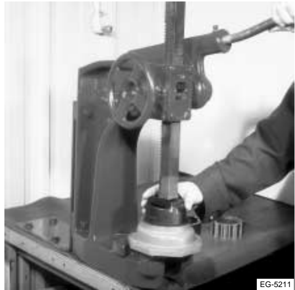
Figura 9.10 Instalación del sello en la bomba de aceite
