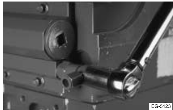
Figura 12.26 Apriete el conector tipo guitarra
