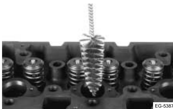
Figura 4.62 Limpieza de la cavidad
