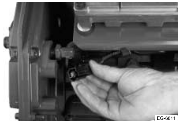
Figura 11.30 Retire el conector del EOT
