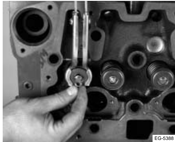
Figura 4.32 Retiro de los retenedores de los resortes
