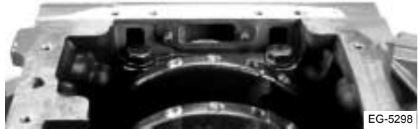
Figura 7.84 Instalación de la empaquetadura del tubo de captación de aceite
