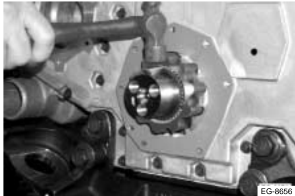
Figura 9.13 Instalación de la chaveta Woodruff
