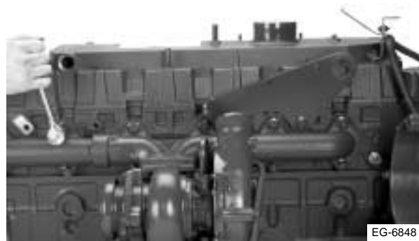
Figura 3.5 Retire el múltiple de escape
