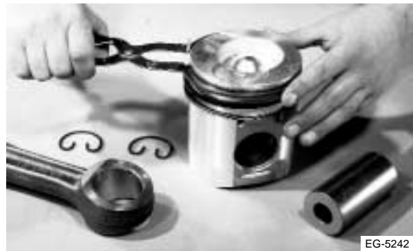
Figura 6.41 Instalación de los anillos (marcas hacia arriba)
