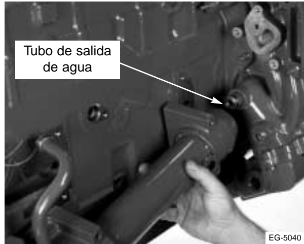
Figura 9.23 Instalación del tubo de salida de agua
