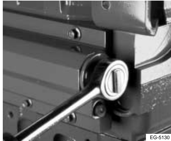
Figura 12.2 Retiro del tapón de extremo
