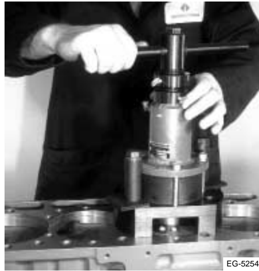
Figura 6.34 Coloque el cortador de abocardados
