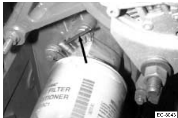
Figura 10.12 Retiro del filtro del refrigerante
