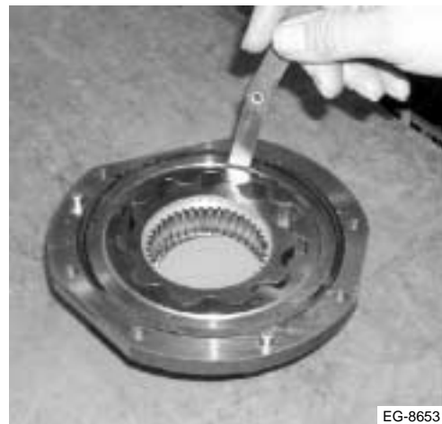
Figura 9.8 Inspección del desgaste de los rotores
