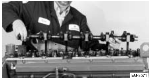
Figura 4.75 Instalación del conjunto de balancines
