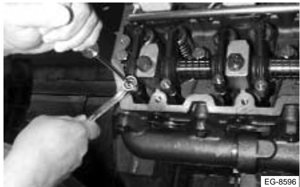
Figura 4.78 Ajuste de las tuercas de seguridad
