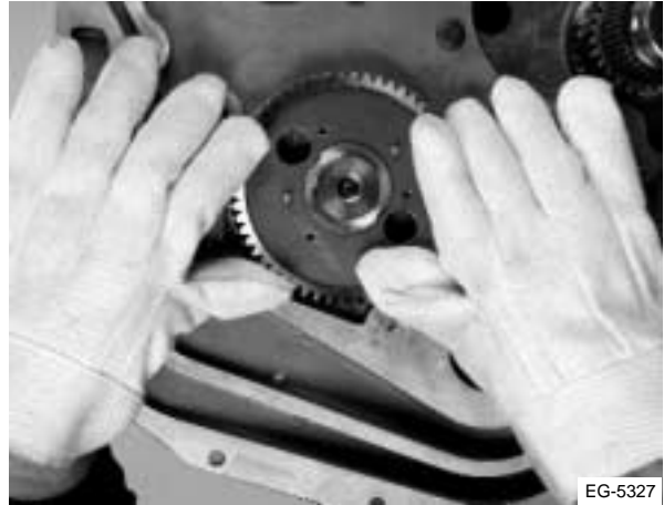
Figura 5.26 Instalación del engranaje en el árbol de levas
