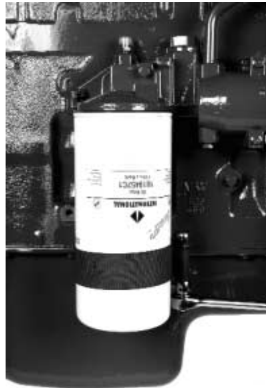
Figura 9.17 Retiro del filtro de aceite
