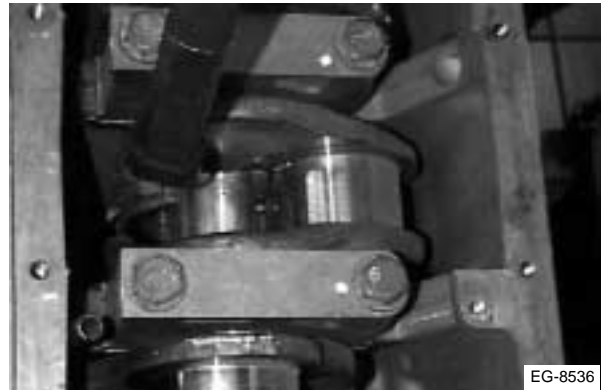
Figura 6.4 Empuje los conjuntos de biela y pistón a través del bloque del motor
