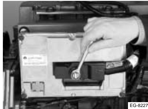
Figura 11.36 Ajuste del conector del ECM
