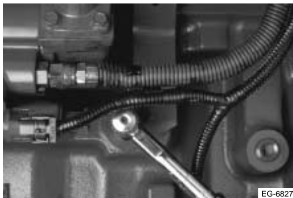
Figura 11.12 Perno inferior del soporte de montaje
