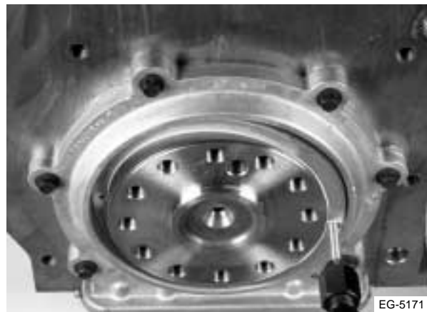
Figura 7.9 Retire del sello de aceite trasero
