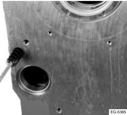
Figura 7.74 Limpieza de las galerías del bloque del motor
