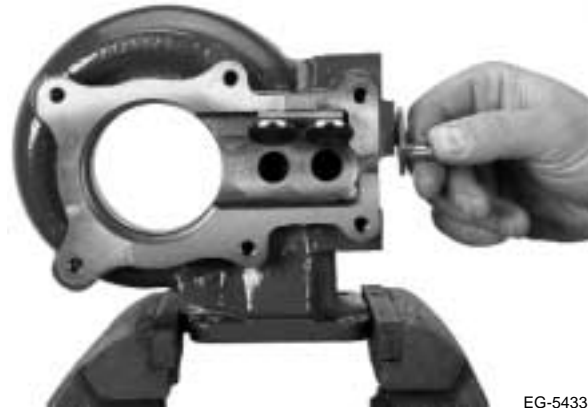
Figura 2.19 Revise las válvulas de la compuerta de descarga
