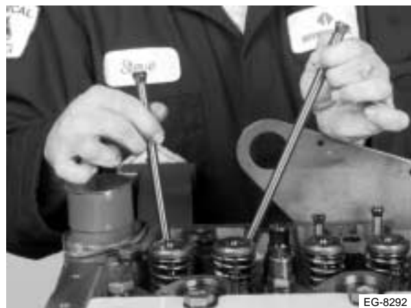
Figura 4.20 Retiro de las varillas de empuje
