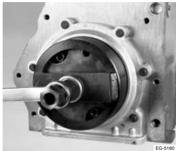
Figura 7.16 Instalación del sello
