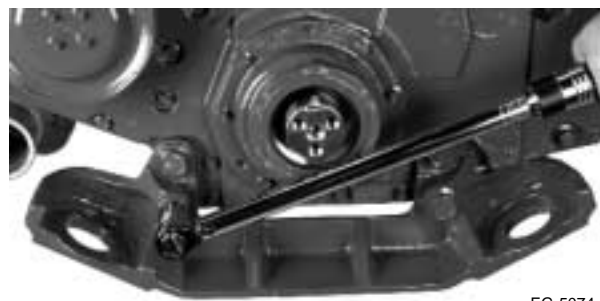
Figura 7.91 Instalación del soporte de montaje delantero
