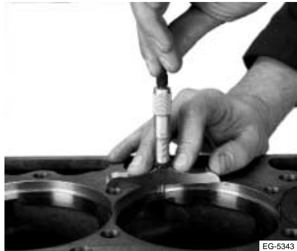
Figura 6.31 Medición de la profundidad de los abocardados con un micrómetro de profundidad
