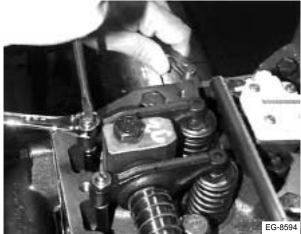
Figura 4.77 Ajuste del juego de las válvulas
