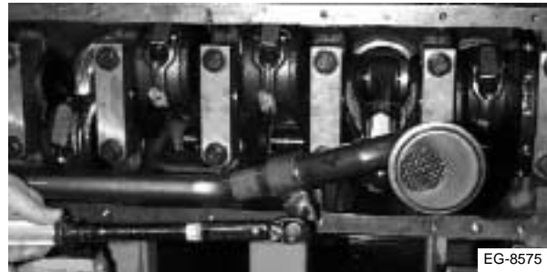
Figura 7.86 Instalación del soporte del tubo de captación de aceite
