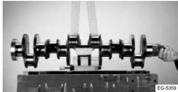
Figura 7.80 Instalación del cigüeñal
