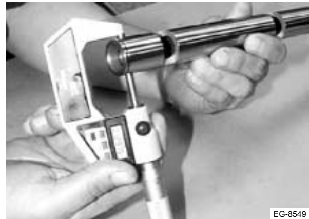
Figura 5.9 Mida verticalmente las áreas que hacen contacto y las que no hacen contacto
