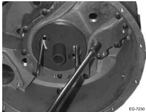
Figura 7.49 Instalación de los 4 tapones roscados
