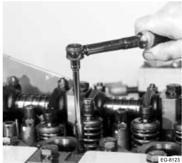
Figura 4.28 Instalación del perno de resalto
