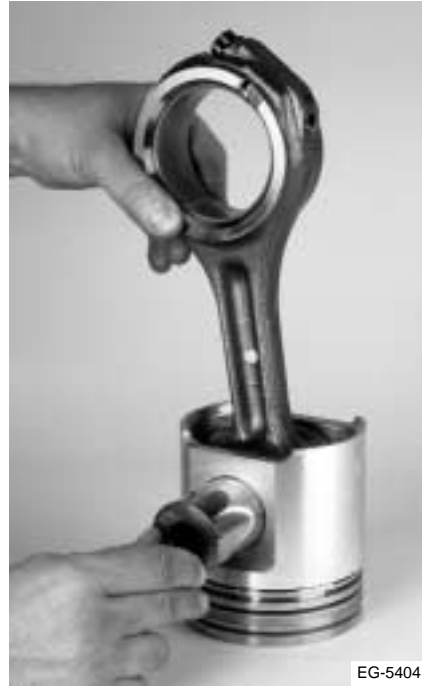
Figura 6.42 Instalación de los pasadores de los pistones
