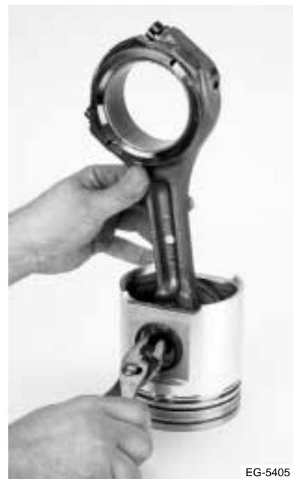
Figura 6.43 Instalación de los anillos de retención de los pasadores
