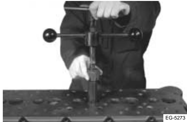
Figura 4.51 Instalación de la boquilla en el asiento de la válvula
