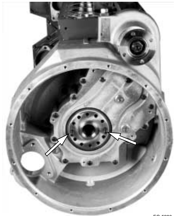
Figura 7.53 Instalación del volante
