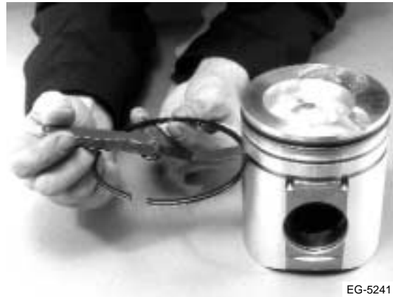
Figura 6.13 Compruebe el juego lateral de los anillos de control de aceite
