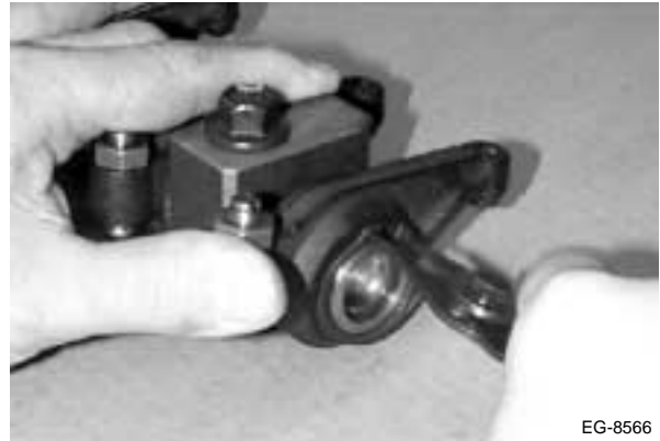
Figura 5.18 Anillo de retención del eje de balancines
