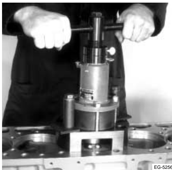
Figura 6.36 Forma de usar el cortador de abocardados
