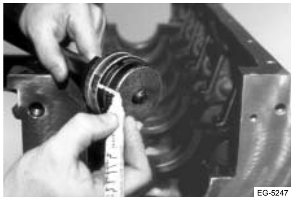
Figura 5.31 Marque la ubicación del orificio del aceite del buje
