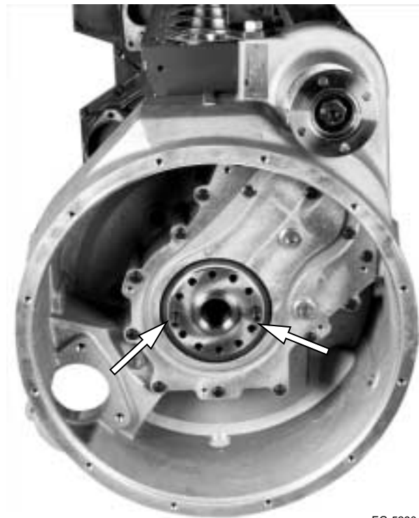
Figura 7.32 Retiro del volante
