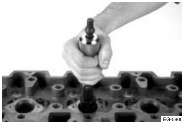
Figura 4.61 Retiro de la camisa
