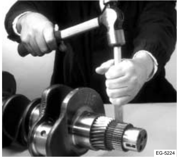
Figura 7.71 Retiro de la estría impulsora de la bomba de aceite
