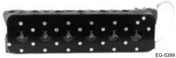
Figura 4.30 Sujeción de la placa de prueba de presión
