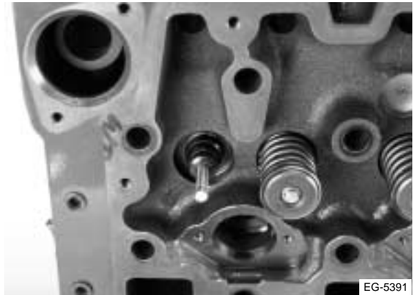
Figura 4.67 Instalación del conjunto del sello del vástago de la válvula
